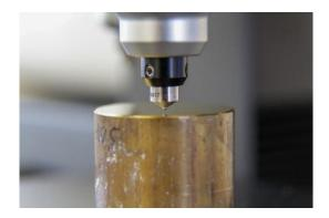
Härteprüfung: Prüfkopf mit Wolframkugel (Brinell)
